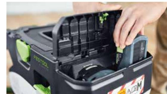
Leistungsstark: Power wie die Kabelvariante dank 36 V-Turbine mit 2 x 18 V-Akkupacks (4,0/5,2/8,0\* Ah).
