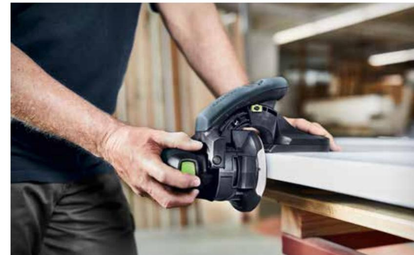
50% schneller im Vergleich zur Arbeit mit dem Schleifklotz: Systainer auf, Kantenschleifer raus und die Kante ist schnell und fehlerfrei geschliffen.
