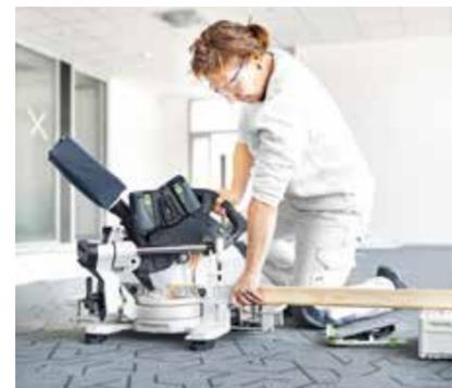
Zusatzfüße erhöhen den Arbeitstisch der KSC 60 exakt auf die Höhe des Systainers SYS 3 M 112 bzw. SYSTAINER SYS 1.
