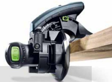
So gelingt die optimale Kante: Der Kantenschleifer liegt vollflächig an der Kante an und sorgt für einen einwandfreien Schliff. Kein Abkippen und kein Durchschleifen – ab der ersten Anwendung. Geeignet für kleine als auch große Werkstücke, schmale und breite Kanten (5–60 mm), schräge Flächen (43–92°) sowie Außenrundungen in der Kontur (z. B. bei einem runden Esstisch). Arbeiten ist bis in Innenecken möglich.
