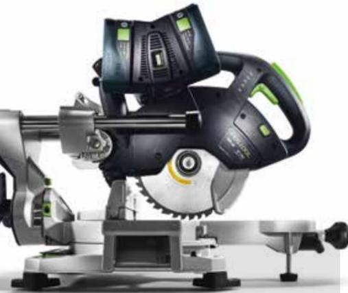
Die Akku-KAPEX KSC 60 liefert unschlagbar präzise Kappschnitte. Und das in einer enormen Anwendungsvielfalt durch beidseitige Gehrungswinkel bis zu 60 Grad und beidseitige Neigungswinkel bis zu 46 bzw. 47 Grad.
