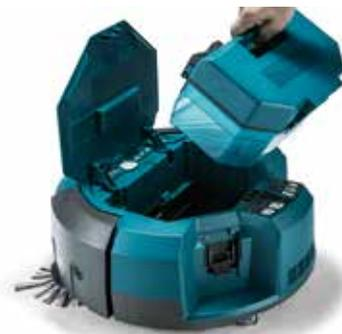
Staubsaammelbehälter mit 2,5 l (DRC200Z) bzw. 3,0 l (DRC300Z) Fassungsvermögen lässt sich zur Reinigung leicht heraus-nehmen. Ausgestattet mit einem Filter-element.
